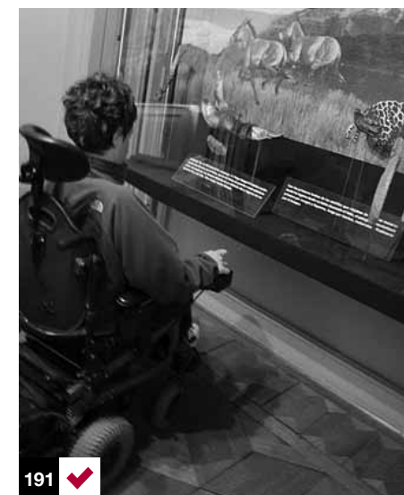
Fotos 190 y 191: vitrinas de exhibición que permiten el acercamiento de una silla de ruedas para observar los contenidos. Munich, Alemania y Punta Arenas, Chile.
