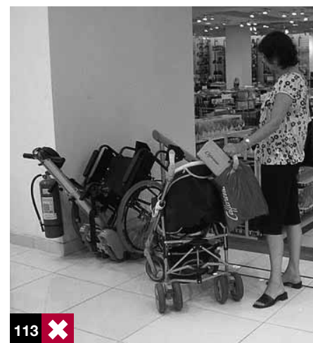
Foto 113: la oruga no resuelve el desnivel para todos. En este caso, un coche de niños no puede salvar el desnivel.
