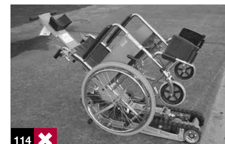
Foto 112: plataforma elevadora para adaptar una circulación con cambio de nivel. No se debieran contemplar en un proyecto nuevo. Santiago, Chile.
