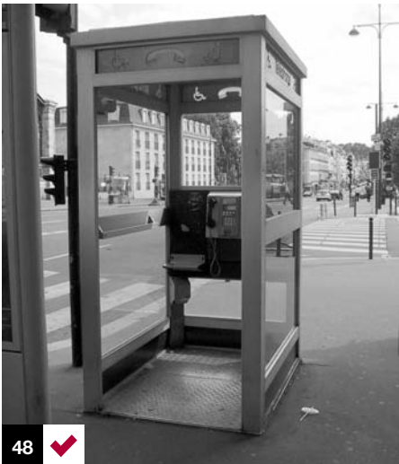
Foto 48: teléfono público de uso universal. Su acceso está nivelado para permitir la entrada de una silla de ruedas.
