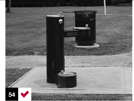
Foto 54: fuente de agua que se adapta a todas las alturas de uso (de pie, sentado y para animales). Ubicada fuera del recorrido peatonal pero con acceso a nivel. Houston, EE.UU.
