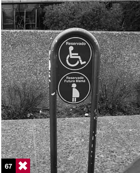
Foto 67: estacionamiento que comparte uso con embarazadas. Deben estar separados físicamente. Carretera 5 Sur, Chile.
