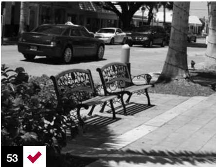
Foto 53: escaños fuera del recorrido peatonal con espacio lateral para acomodar un coche o silla de ruedas. Naples, EE.UU.
