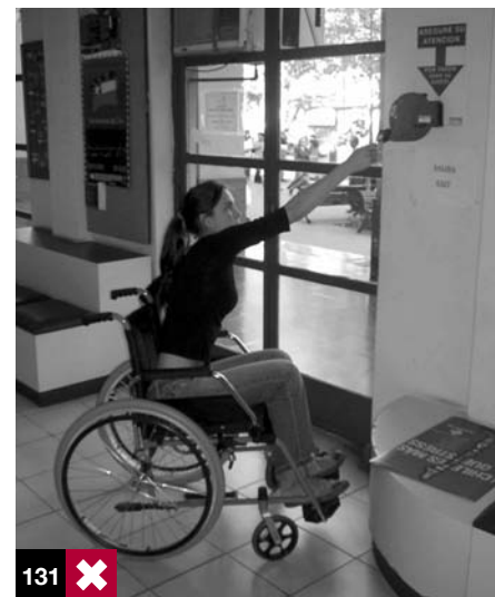
Foto 131: dispensador de ticket colocado a altura fuera del rango de alcance. Santiago, Chile.
