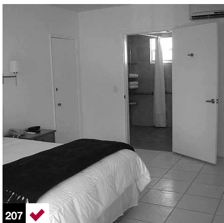
Foto 207: habitación de uso universal. Puerta de baño abre hacia afuera por razones de seguridad. Hotel en Miami, EE.UU.
