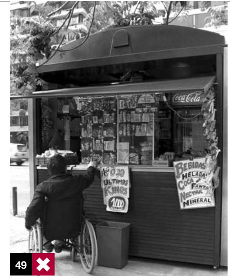
Foto 49: kiosco que no permite la visión ni el acceso a los productos en exhibición.
