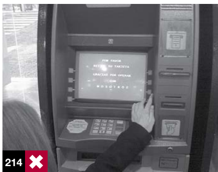
Foto 214: cajero automático que no permite su uso desde una silla de ruedas. Santiago, Chile.
