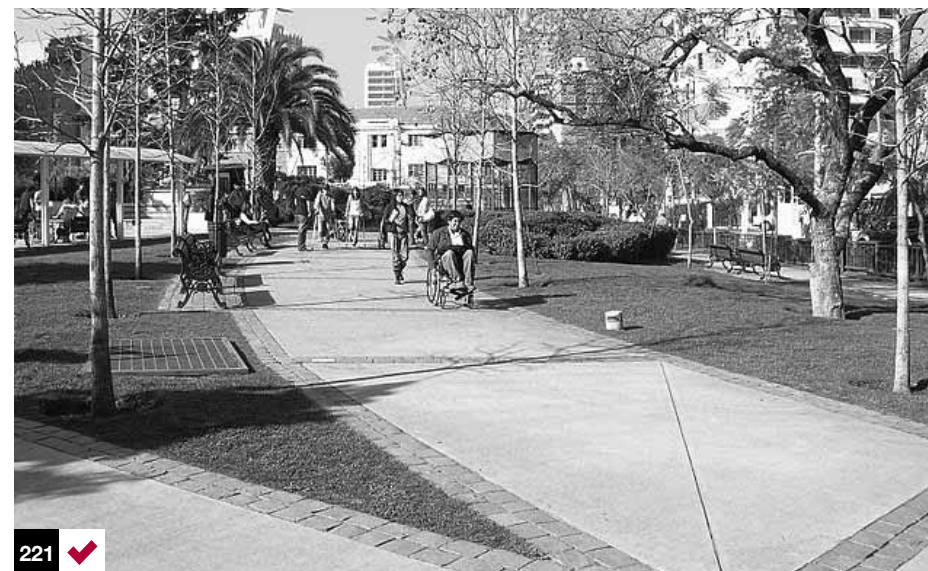
Foto 221: senderos en plaza de buen ancho y cambio de texturas que delimitan los espacios y encuentros de circulación peatonal. Plaza en Las Condes, Santiago, Chile.
